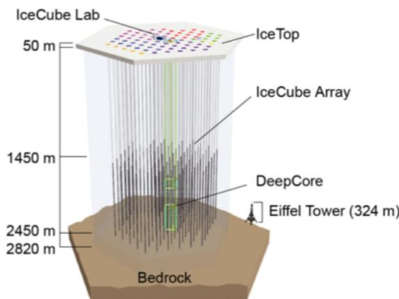
Neutrinos sind elektrisch neutrale Elementarteilchen mit sehr kleiner Masse. Da sie fast unabgeschwächt durch alles (z.B. die Erde) hindurchgehen, können sie Aufschluss über Vorgänge im All geben, Geburt von Sternen, Supernovae... Sie können mit Tscherenkov-Licht-Detektoren im Eis erfasst werden.
