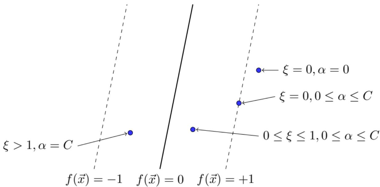
Beispiele  $\vec{x}_i$  mit  $\alpha_i > 0$  sind Stützvektoren.
